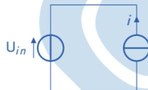
La charge de la sortie sera modélisée par une **source de courant** car elle est potentiellement *réversible* et d'après les critères d'association des sources, seules une source de tension et une source de courant peuvent être associées directement.
